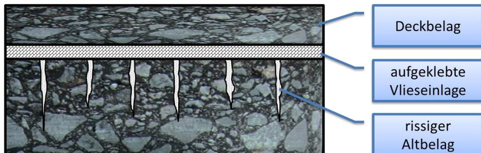
Derart aufgeklebte Spezialvliese reduzieren das gefürchtete Übertragen von Belagsrissen auf den Deckbelag und verlängern dadurch die Lebensdauer der bituminösen Deckbeläge und der Strassen im Allgemeinen.
